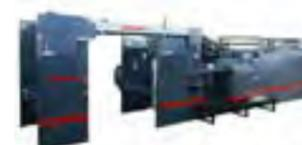
飞达座：E 型低台堆纸板设计，可将待贴合纸张以拖板车推入就位，可选配加装轨道辅助预叠堆纸台
